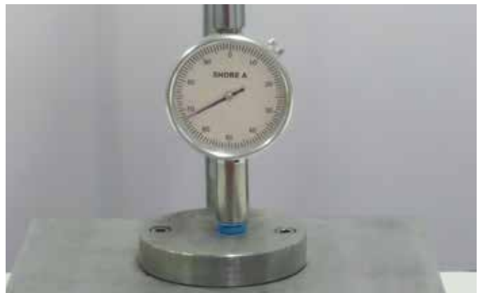
La resistencia a compresión y la dureza de la goma, parámetros fundamentales para el correcto funcionamiento de la abrazadera.
